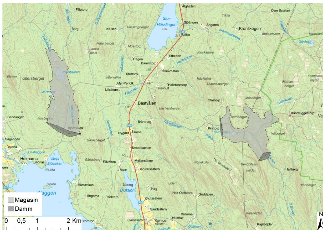
Figur 2. Kartbild med markeringar i grått för den planerade anläggningens nya magasin med dammar. Till vänster det planerade nedre magasinet vid Utterstjärnen och Björsviken. Till höger det övre magasinet vid Tjärnbergstjärnen. © Lantmäteriet.
